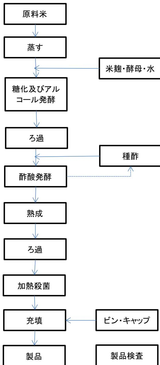
すし酢の一般的な製造工程を示します。
